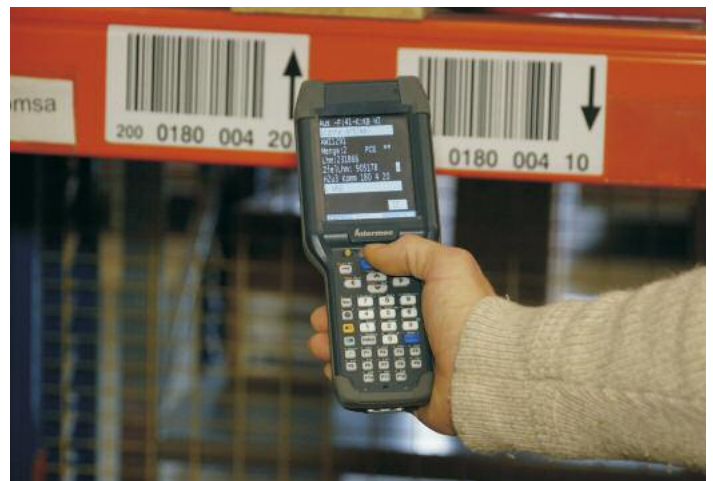
Der Mobilcomputer mit seiner übersichtlichen Benutzerschnittstelle kommuniziert mit dem Lagerverwaltungssystem
