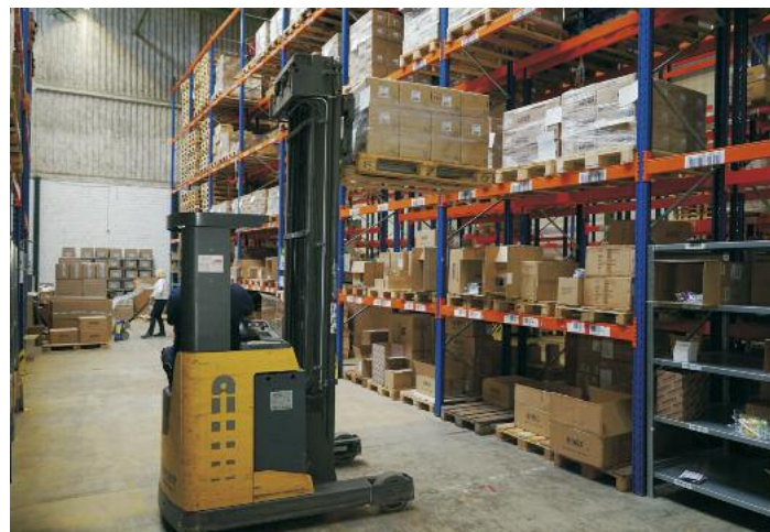
Neben den Barcodes der Lagerplätze werden in Entfernungen von bis zu 8 m auch die 1D-Codes der Artikel eingescannt
